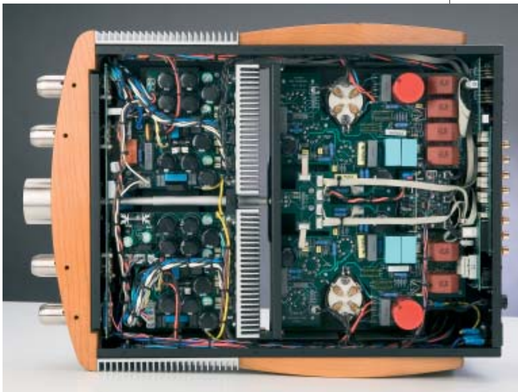
L'ingresso fono è collocato su una basetta sospesa, ovviamente allo scopo di minimizzare la trasmissione delle vibrazioni. L'anello semichiuso che circonda il triodo d'ingresso, di gran lunga il più esposto alla microfonicità, ha scopo analogo rispetto alla tendenza risonante del vetro dei tubi.
