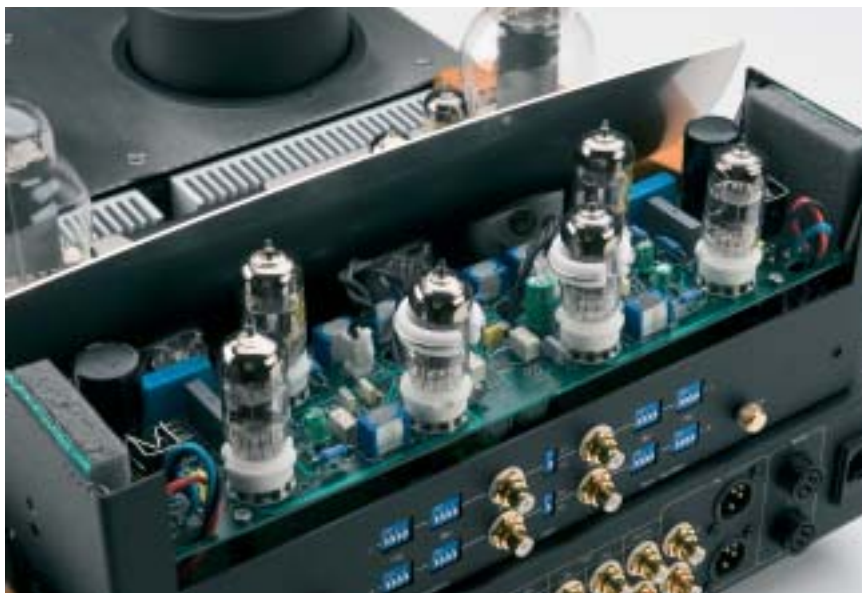
L'ingresso fono è collocato su una basetta sospesa, ovviamente allo scopo di minimizzare la trasmissione delle vibrazioni. L'anello semichiuso che circonda il triodo d'ingresso, di gran lunga il più esposto alla microfonicità, ha scopo analogo rispetto alla tendenza risonante del vetro dei tubi.
