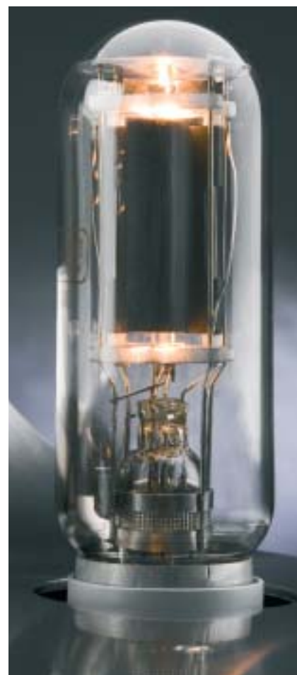
Il triodo a riscaldamento diretto 845, che potremmo vedere come "fratello maggiore" del più famoso triodo a riscaldamento diretto 300B usato nel pre. Il modello 845 è stato reso famoso proprio dalle realizzazioni Unison, tra le quali il modello Absolute 845.
