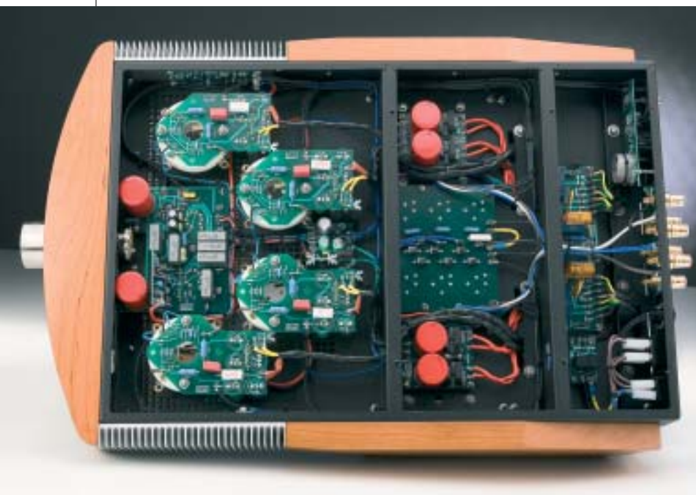
Lato inferiore del finale Reference. Ogni monofonico impiega due trasformatori di alimentazione da 400 VA, per un totale di 16 secondari.
